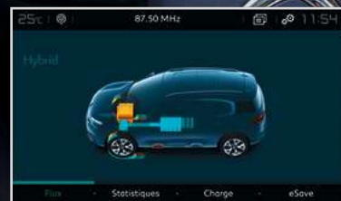
ENERGIEFLUSS: Visualisierung der Funktionsweise der Hybridtechnologie.
